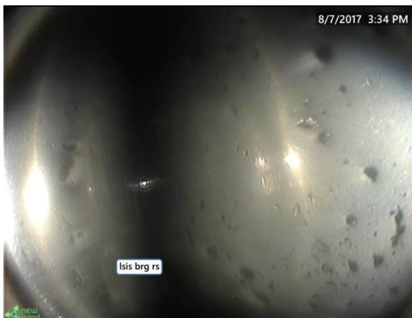
Imagem 14: Pista interna e elemento rodante do rolamento – LSIS rotor lateral, depois do tratamento
