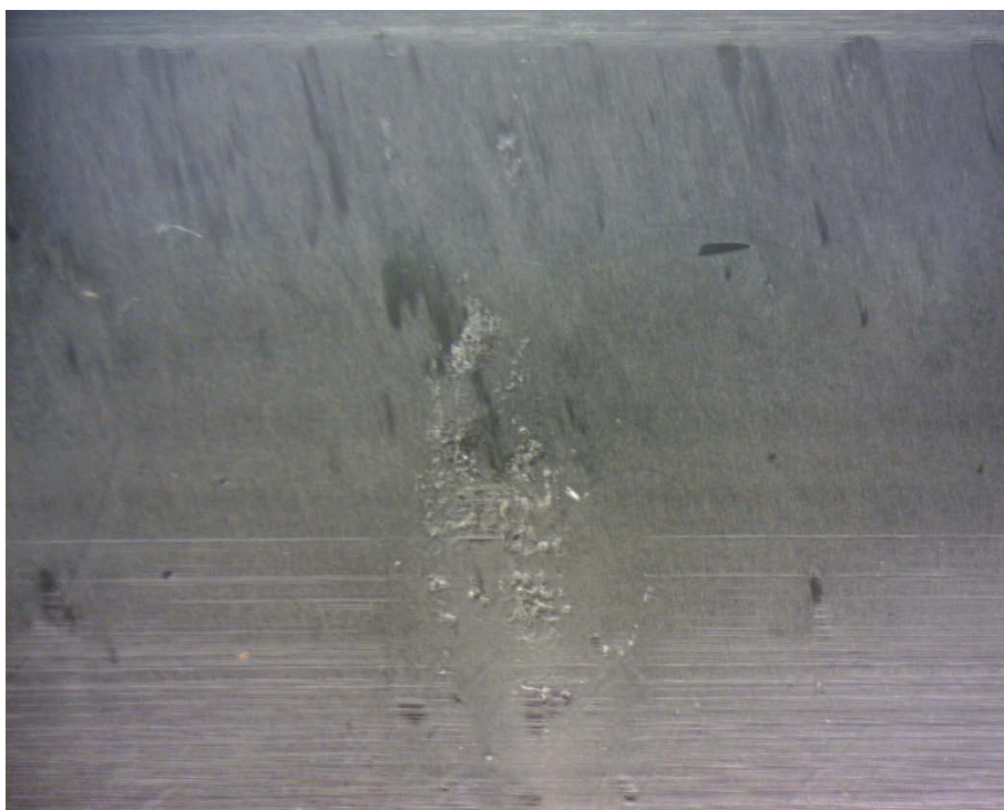
Imagem 8: Impressão da superfície depois da aplicação no gearbox da turbina eólica nº AB VIII – AEG 01
