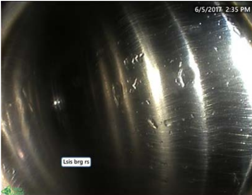
Imagem 15: Pista interna e elemento rodante do rolamento – LSIS rotor lateral, antes do tratamento
