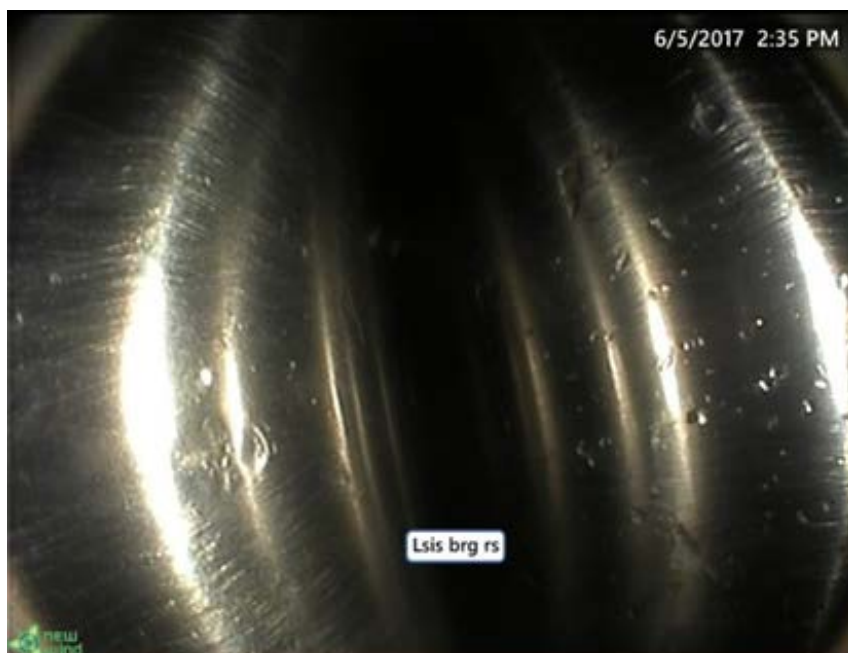
Imagem 13: Pista interna e elemento rodante do rolamento – LSIS rotor lateral, antes do tratamento
