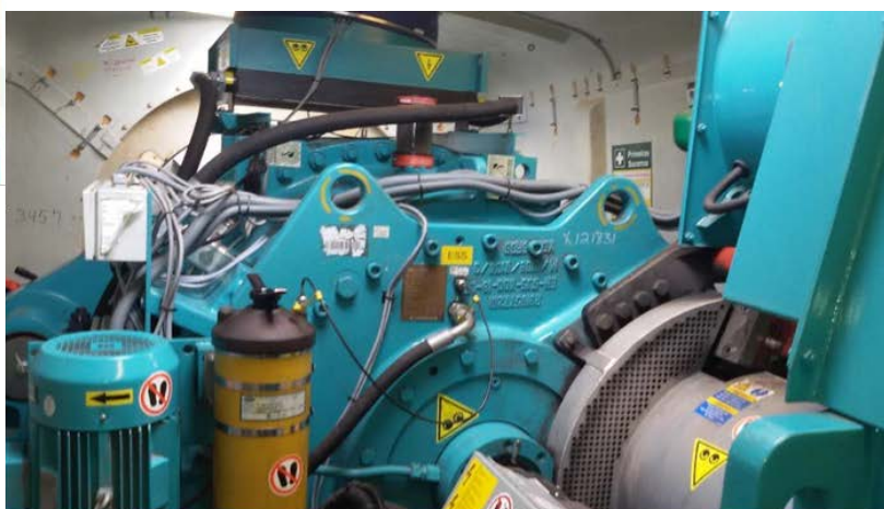
Imagens 1 e 2: placa de identificação do gearbox Rexroth e vista do gearbox tratado com REWITEC®
